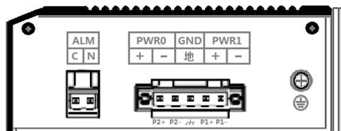
告警      DC端子接地      接地柱接地
