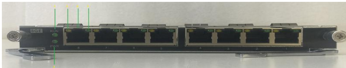
图 2.3-7 8GE 电口卡指示灯及接口示意图
