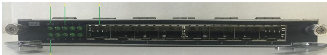
图 2.3-9 8GE 光口卡指示灯及接口示意图
