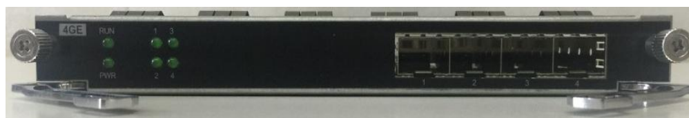
图 2.3-11 4GE 光口卡外观示意图
