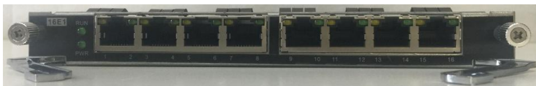
图 2.3-13 16E1 卡外观示意图
