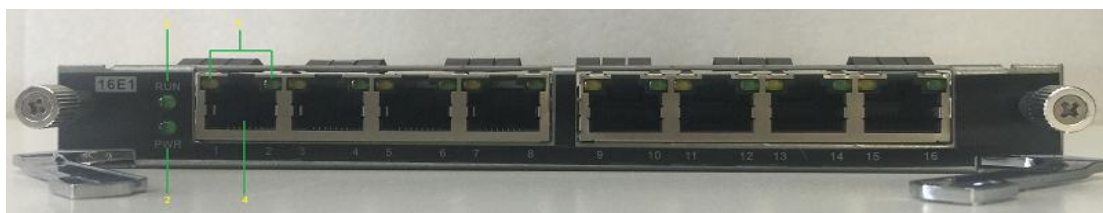
图 2.3-14 16E1 卡指示灯及接口示意图
