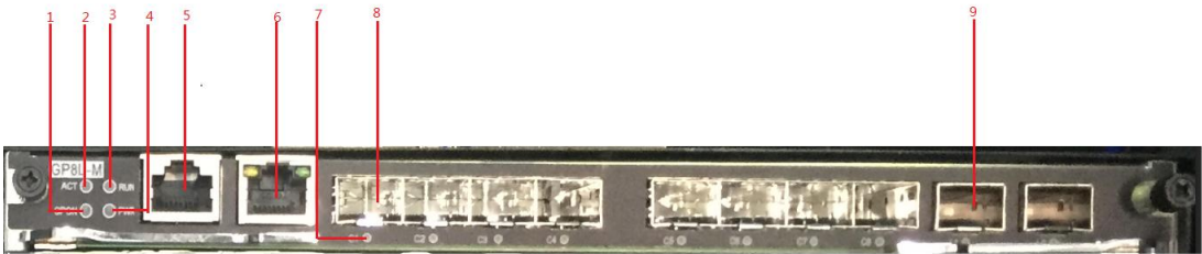
图 2.4-5 GP8N-M PON 口卡指示灯及接口示意图
