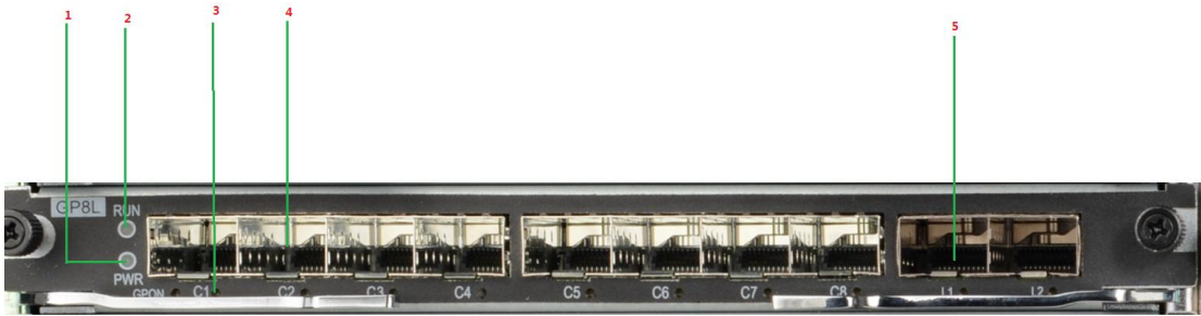
图 2.3-5 GP8L PON 口卡指示灯及接口示意图
